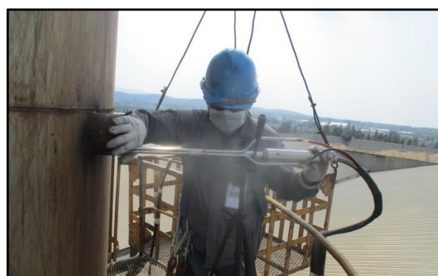
ภาพที่ 3.1-2 จุดตรวจวัดคุณภาพอากาศจากปล่องระบาย บริเวณปล่องระบายของหม้อไอน้ำ (120 ตัน)
